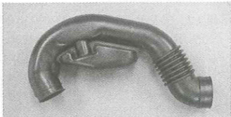
写真7 ①PP, TPO 製レゾネーター一体エアダクトパイプ (富士重工業(株)・レガシー, 2009年モデル)<sup>10)</sup>, ②レゾネーター一体型の場合, 従来部品に比べて以下の特長を持つ。(i) 部品点数の削減(50~85%削減), (ii) 組付け点数の低減, (iii) 軽量化(30~70%低減), (iv) コスト低減化(20~50%低減)((iii)と(iv)の特長は,(i)と(ii)による), ③多機能(Multi-Functional) エクステンジブロー法(エクセル(株)), ④材料のハード部分(ダクトとレゾネーターを一体化)はPP, ソフト部分はTPO
