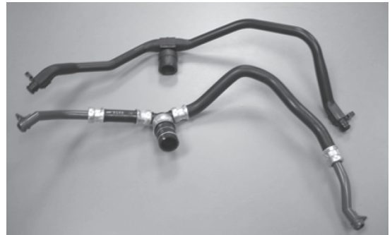
写真10 ブローバイパイプ ((上) MESエクスチェンジパイプ (本体：PA6+TPAE)、(下) 従来のパイプ (金属パイプ+ゴムホース+クランプ))
