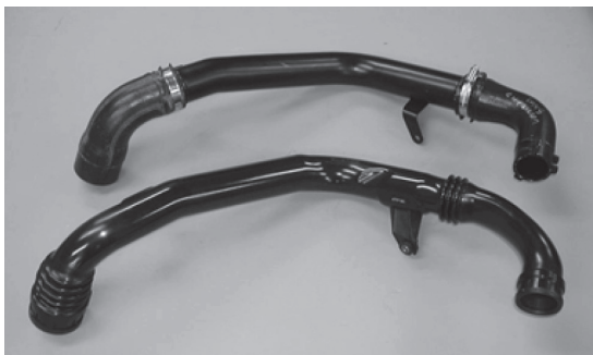
写真9 ポリエステル系ターボエアインテークパイプ (過給高温側) ((上) 従来のターボパイプ本体：金属ダクト、両端：繊維強化ゴムホース、(下) MESエクスチェンジパイプ本体：PBT-GF、両端・蛇腹部：TPC)
