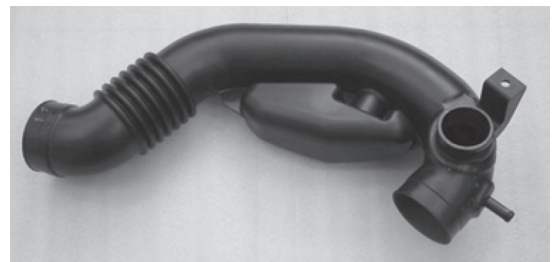
写真11 多機能エクスチェンジブロー成形 (MF-Exchange Blow Molding) による製品例 (両端組付け部・蛇腹部：TPV、本体部・レゾネータ部：PP、レゾネータ部は一体成形)
