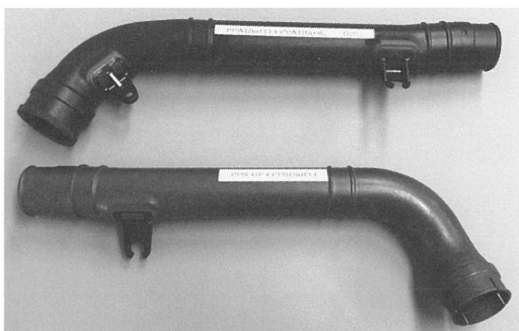
(上) 本体：PPA-GF，端末部：PPA-Soft (下) 本体：PPS-GF，端末部：PPS-Soft
