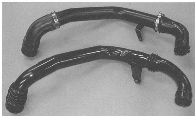
(上) 従来品のターボパイプ 本体：金属パイプ、両端：繊維補強ゴムホース (下) MES-エクスチェンジパイプ 本体：PBT-GF、両端部・蛇腹部：TPC
